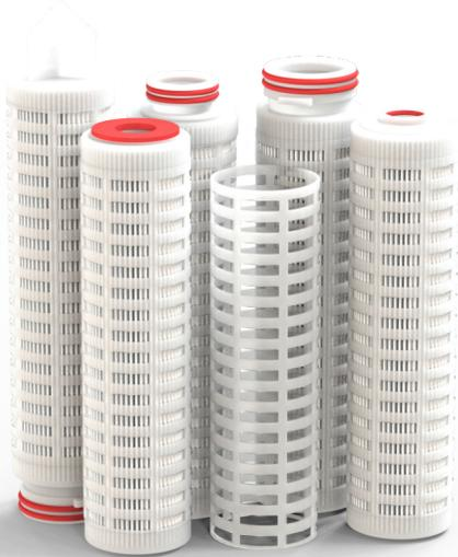
PG Filterelemente sind komplett aus Polypropylen gefertigt. Der mehrlagige Aufbau und die Plissierung des Filtermediums garantieren eine hohe Partikelaufnahme bei gleichzeitig geringem Anfangsdifferenzdruck.
